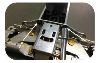
**2.** SLIDE HOUSING OFF DEVICE EXPOSING THE BASERAIL AND PUSHPAD.
