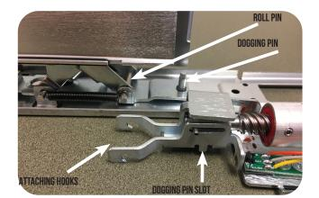
**5.** MAKE SURE DOGGING PIN LINES UP TO SLOT ON THE UNDERSIDE OF THE KIT AS YOU GRAB ONTO THE ROLL PIN.
